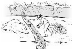
7. Construcción de drenajes internos
