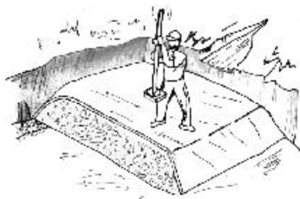
3. Inicio de la operación del relleno
