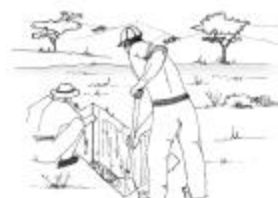
Verificación del nivel freático
