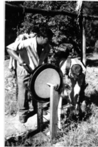
Extracción manual de agua de pozo
