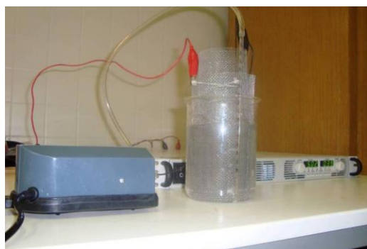
FIGURA 2 SISTEMA COMPLETO, INCLUYENDO EL AIREADOR
