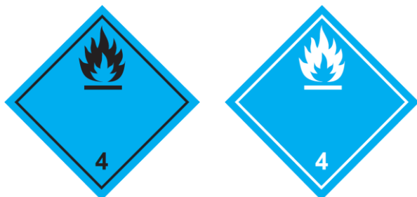
División 4.3: Sustancias que, en contacto con el agua, desprenden gases inflamables
