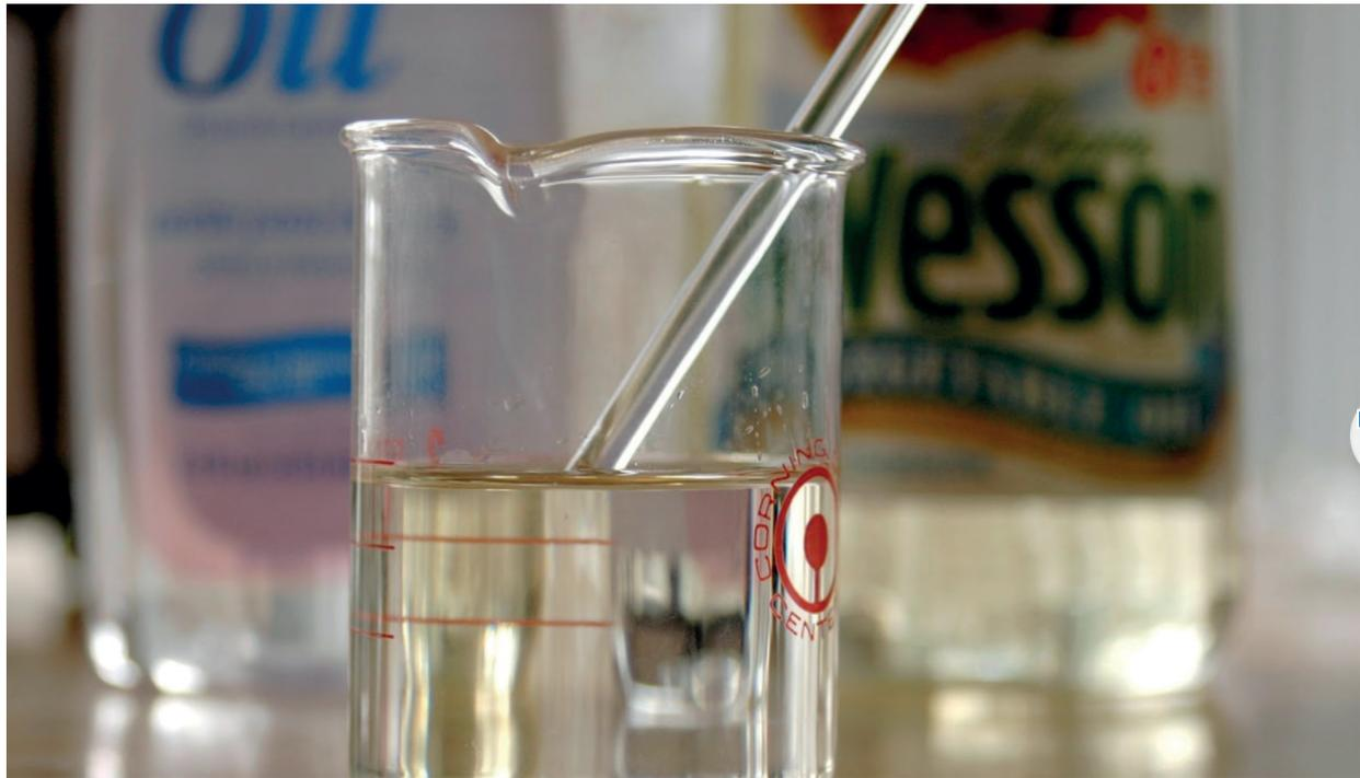
**Nota:** Para verificar que el índice de refracción del aceite de inmersión es mayor a 1,5 coloque una porción del aceite en un recipiente de vidrio. Si al introducir en el aceite una varilla de vidrio, ésta se torna invisible, implica que el índice de refracción del aceite es superior a 1,5.
