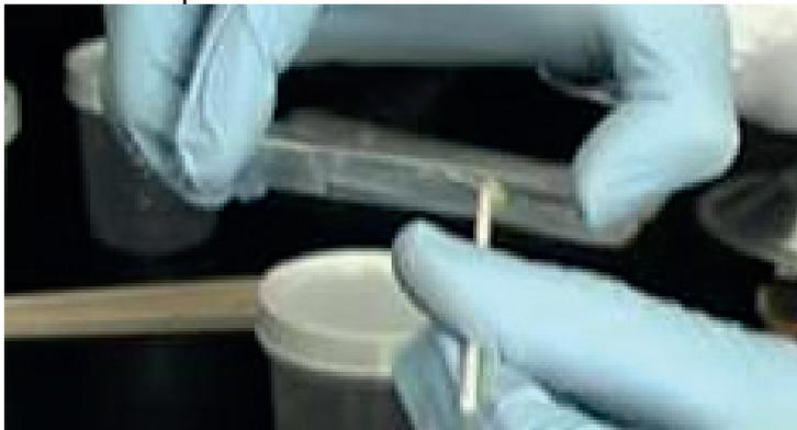
Colocar la(s) partícula(s) seleccionada(s) sobre el portaobjetos y extenderla(s) con el aplicador con movimientos suaves, circulares, tratando de dispersarla en forma homogénea en el centro de la lámina, dibujando un óvalo de 2 cm de largo por (1 a 2) cm de ancho, sin llegar a los bordes de la lámina para evitar que el operador se contamine al manipularla.
